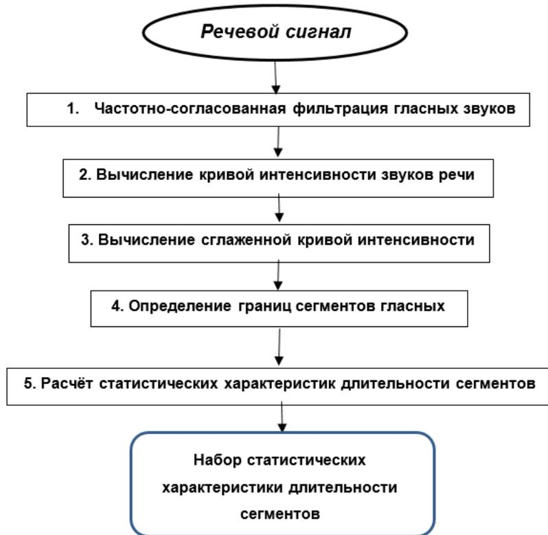
Рис. 5: Алгоритм предварительной обработки речевого сигнала.
